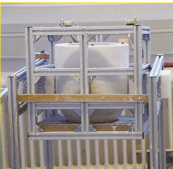
Die Gießform in ihrer Drehvorrichtung.
